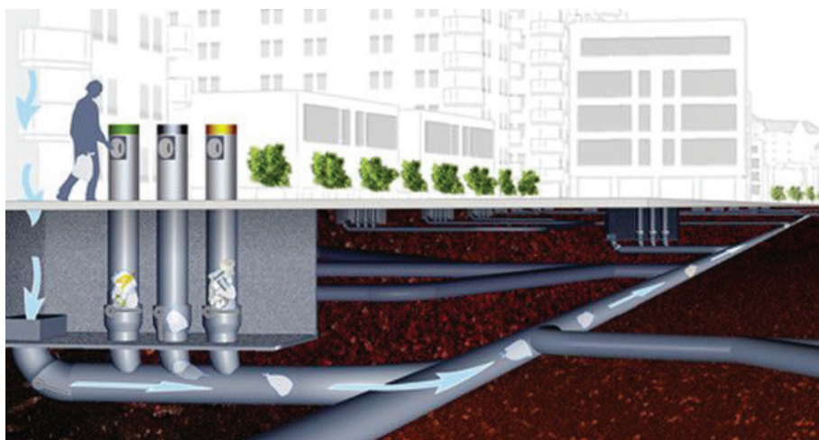
Rys. 3. System próżniowej zbiórki odpadów – First Recykling Sp. z o.o. [11]
